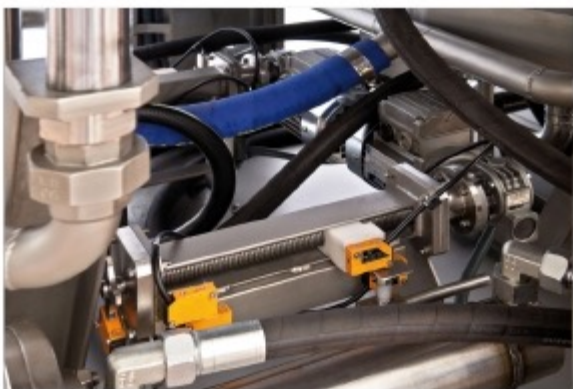
Regulación por sensores con un recorrido de 0 a 190 válvulas especiales de llenado.
