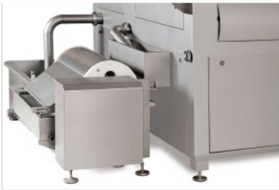
Sistema de filtraje de la salmuera con filtro de tambor.
